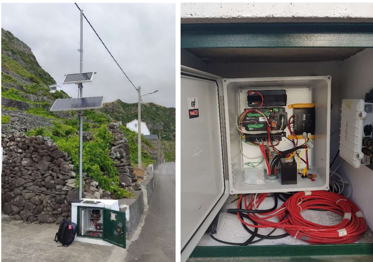
Figura 13 – Nicho de proteção dos sistemas de aquisição, transmissão e alimentação da Rede Piezométrica Permanente da Maia.
