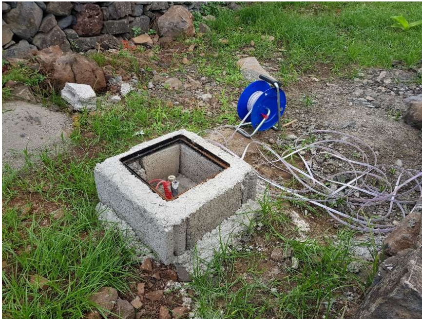
Figura 12 – Nicho de proteção do furo de sondagem FSM3, onde foram colocados um piezómetro de corda vibrante e um piezómetro de Casagrande.
